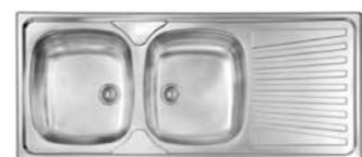
LAVELLO INOX AD INCASSO REVERSIBILE CON 2 VASCHE DA 120 CM 120 CM REVERSIBLE 2 WAYS INOX RECESSED SINK Dimensioni - Size: L.116 P.50 cm Profondità vasca - Tank depth: 15 cm Vol. imballo - Packaging: 0,14 m 3 - KG. 6 Imballo - Packaging: 122x57x20 cm
