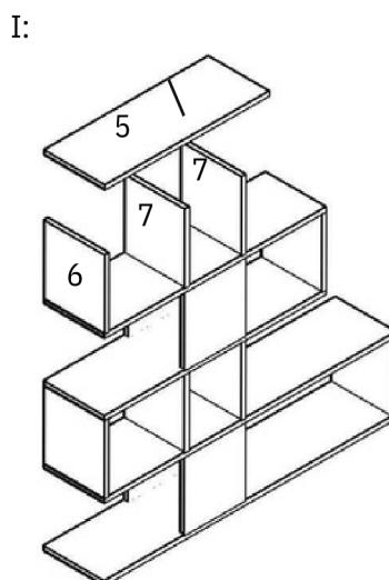
I: 5 Nolu parçamiza askı L demirlerimizi 35\*18 vidalar yardımı ile montajlayalım ardından 7 ve 6 nolu parçalarımıza ustten minifixleyelim.
